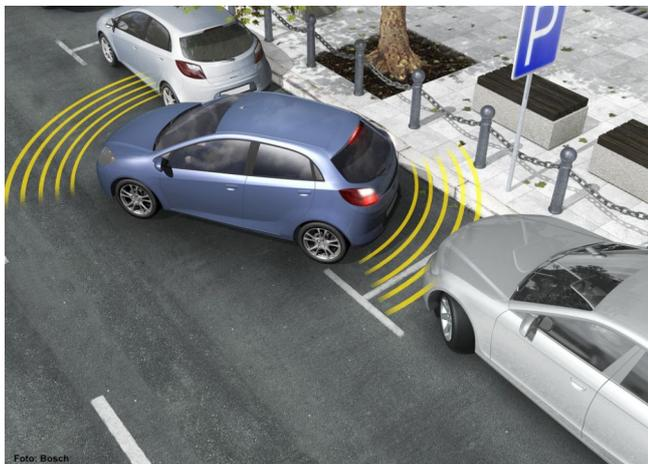
Mit in der Fahrzeugfront und dem Fahrzeugheck integrierten Ultraschallsensoren überwachen Einparkhilfe-Systeme den Nahbereich vor und hinter dem Fahrzeug. Dazu senden die Sensoren Ultraschallsignale aus und empfangen deren Echo. Aus der Zeitdifferenz ermittelt das System den Abstand bis zum Hindernis. Auf diese Weise erkennen Einparkhilfe-Systeme rechtzeitig Hindernisse. Dem Fahrer wird die Distanz je nach Hersteller und System entweder rein akustisch, oder optisch und akustisch angezeigt.
