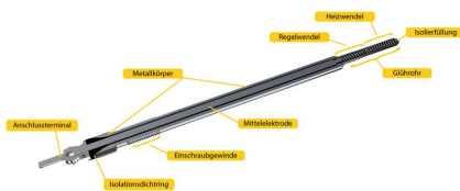
Querschnitt Metallstabglühkerzen
