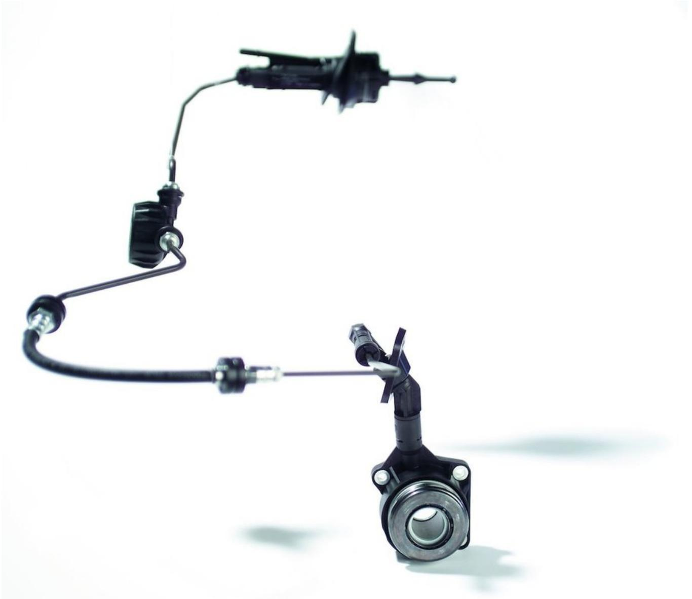
Bei einem Kupplungsbetätigungssystem wird die Unterbrechung der Kraftübertragung vom Fahrer gesteuert indem er Kraft auf das Fußpedal ausübt. Die Kraft wird über mehrere Komponenten übersetzt und an das eigentliche Kupplungssystem weitergeleitet. Wird der Fuß vom Pedal genommen, erfolgt der Prozess in umgekehrter Reihenfolge. Bei einem hydraulischen Kupplungsbetätigungssystem
