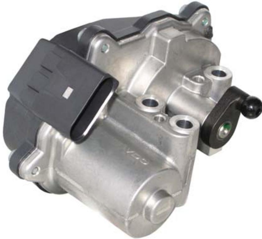
Luftklappen-Stellmotoren sind elektrische Aktuatoren mit integriertem Positionssensor und wahlweise integrierter Elektronik. Sie ermöglichen die kontinuierliche Verstellung von Saugrohrklappen oder Turbolader-Leitschaufeln. Durch ihre präzise Steuerung ersetzen sie außerdem herkömmliche pneumatische Antriebe, die den gestiegenen Anforderungen nicht mehr gerecht werden.
