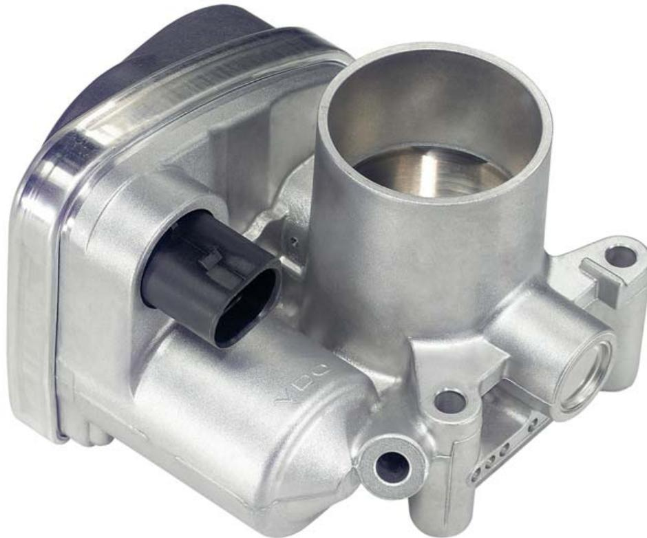
Bei elektronischen Drosselklappen besteht keine direkte Verbindung zum Gaspedal. Der Lastwunsch wird von einem elektronischen Gaspedal (E-Gas) erfasst. Das Motormanagement gleicht dieses Signal permanent mit allen weiteren verfügbaren Daten der Motor-Sensorik ab. Daraus wird die jeweils optimale Drosselklappenstellung errechnet. Die elektronische Drosselklappe wird anhand des Steuersignals vom Motormanagements ausschließlich mit Hilfe eines Stellmotors angesteuert.
