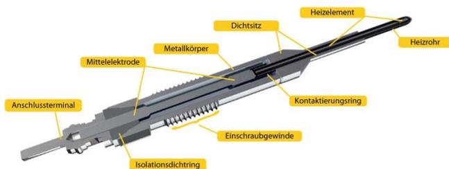
hineinragen. Das sorgt dafür, dass der Dieselmotor bei niedrigen Außentemperaturen sicher anspringt und während der Warmlaufphase geräusch- und emissionsarm läuft. Die Glühkerzen müssen in einer möglichst kurzen Zeit eine hohe Temperatur zur Zündunterstützung bereitstellen. Zudem müssen sie diese Temperatur unabhängig von den Randbedingungen halten und sogar in Abhängigkeit von diesen anpassen.
