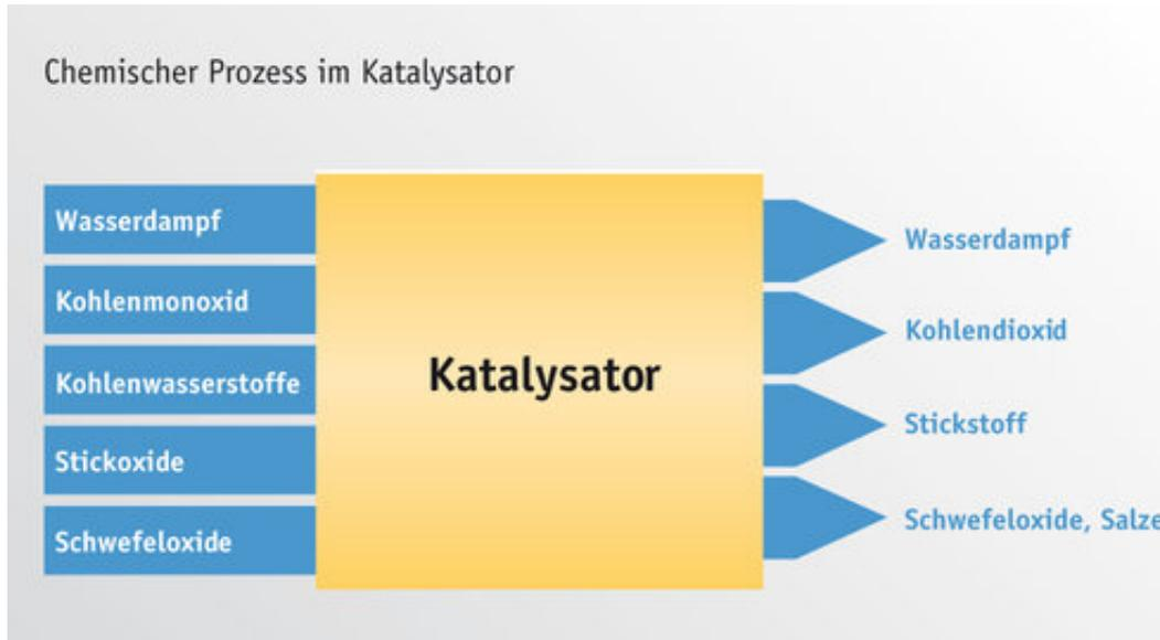
Moderne Abgasnachbehandlungssysteme tragen einen großen Beitrag zur spürbaren Verbesserung der gesundheitlichen Bedingungen bei. Bei dem Verbrennungsprozess im Motor entstehen neben den Hauptbestandteilen Wasser ( $H_2O$ ), Kohlendioxid ( $CO_2$ ) und Stickstoff ( $N_2$ ) folgende Schadstoffe:
