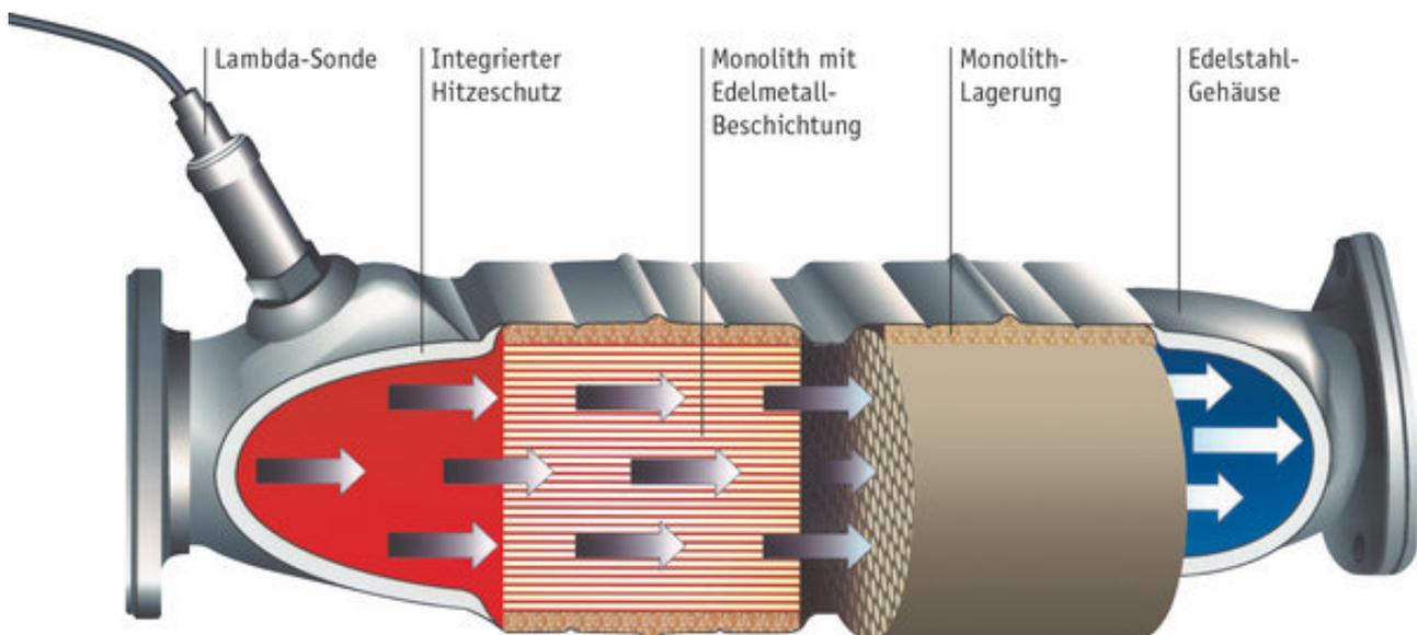
Ein Katalysator besteht aus einem Edelstahlgehäuse. In diesem ist ein metallischer (Metalith) oder keramischer (Monolith) Träger gelagert. Der Träger ist in Längsrichtung von vielen kleinen Kanälen durchzogen. Ziel ist es, damit eine möglichst große Oberfläche zu schaffen, so dass der Katalysator eine optimale Wirkung hat. Die Trägeroberfläche wird mit einer hochporösen Schicht (Wash-Coat) versehen. In diese sind Edelmetalle (Platin, Palladium und/oder Rhodium) eingelagert.
