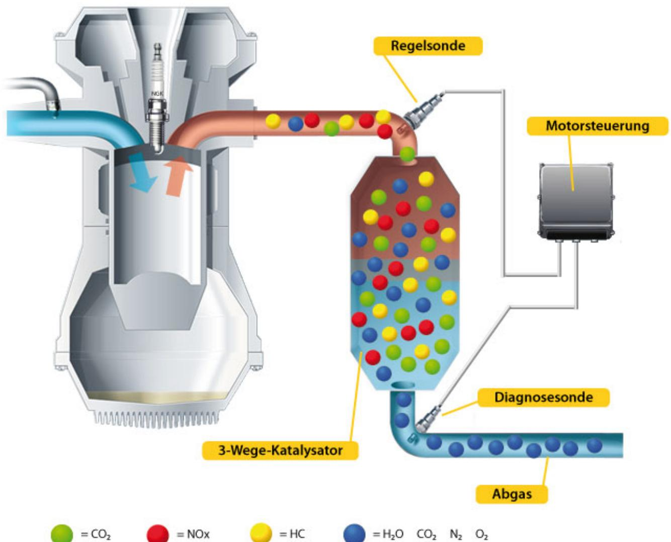
Durch den Messwert der Lambdasonde ist das Steuergerät in der Lage, die Einspritzmenge so zu regeln, dass eine optimale Gemisch-Zusammensetzung gewährleistet ist, um ideale Voraussetzungen für die Abgasbehandlung im Katalysator zu schaffen. Dabei wird auch die Motorlast mit berücksichtigt.
