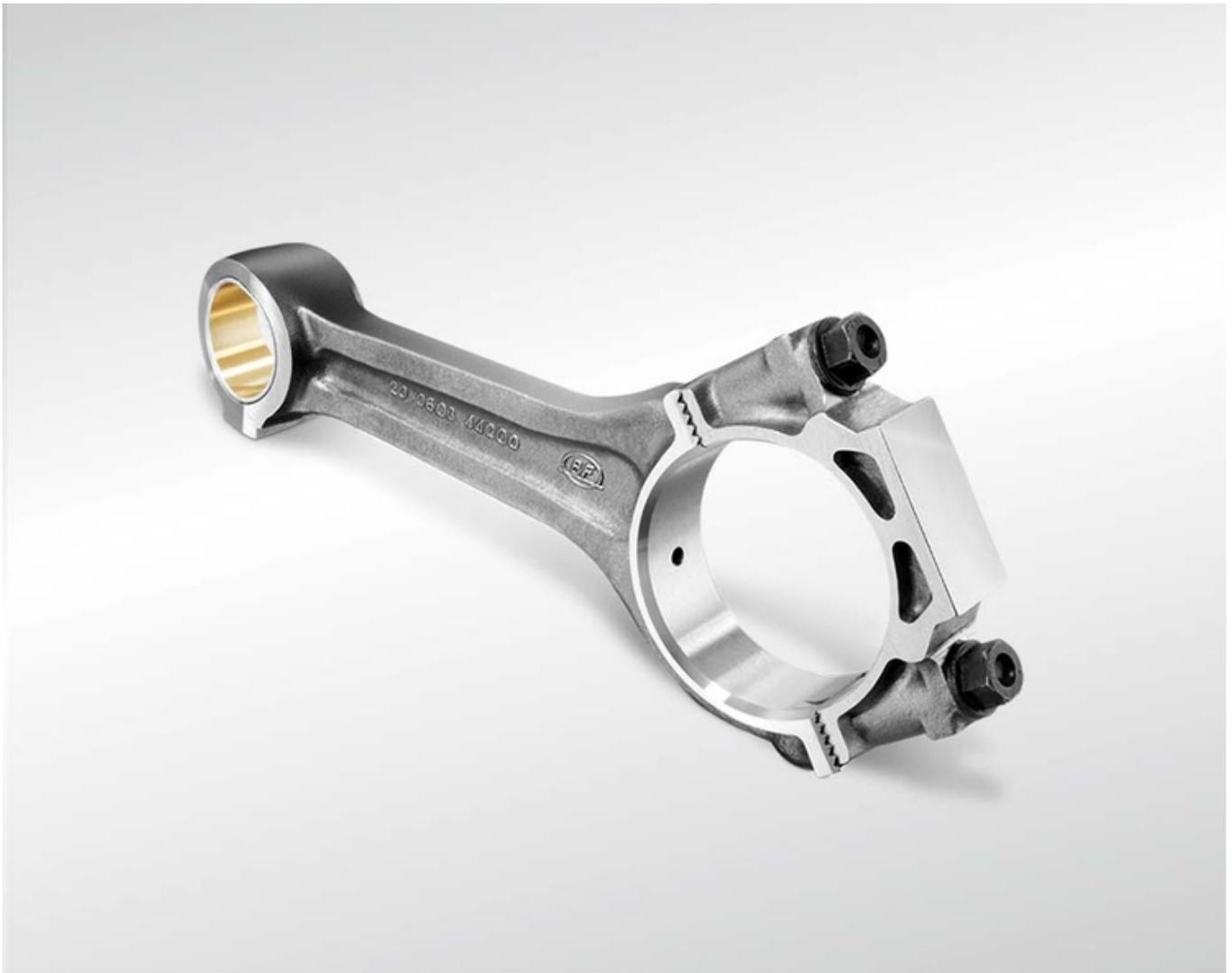
Die Pleuelstange ist auf dem Kurbelzapfen der Kurbelwelle mit einem Gleitlager gelagert. Der Pleuellagerdeckel wird am Pleuelfuß mit Dehnschrauben befestigt. Das Pleuel ist in den meisten Fällen
