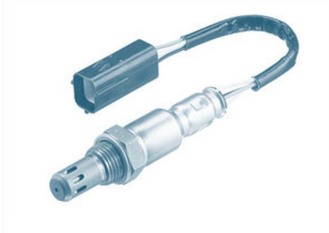
Aus diesem Spannungssignal bestimmt das Motorsteuergerät die aktuelle Gemischzusammensetzung. Bei Sprungsonden, die auch als „binäre“ Lambdasonden bezeichnet werden, pendelt das SONDENSIGNAL zwischen zwei Werten hin und her. Je nach Zusammensetzung wird die Kraftstoff-Einspritzmenge reduziert (wenn das Gemisch zu fett ist) oder erhöht (wenn das Gemisch zu mager ist).
