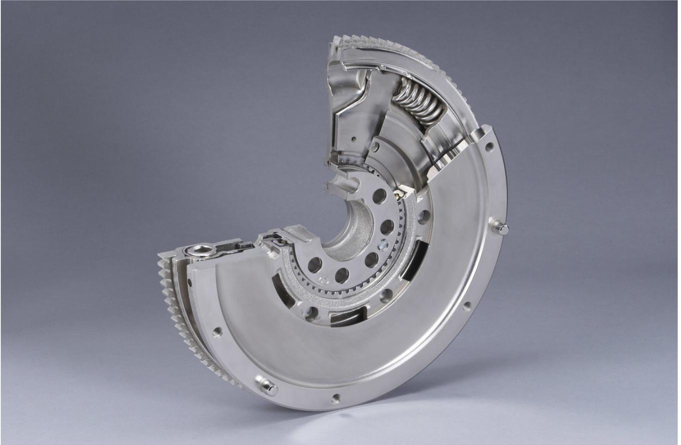
Bei einem Zweimassenschwungrad handelt es sich um ein Schwungrad mit integriertem Drehschwingungsdämpfer. Es verhindert, dass Drehschwingungen des Hubkolbenmotors auf den Antriebsstrang übertragen werden. Das ZMS entkoppelt die vom Motor ausgehende primäre und die vom Getriebe ausgehende sekundäre Schwungmasse über ein Feder-Dämpfungssystem. Durch diesen Vorgang werden Drehschwingungen und die daraus hervorgehenden Geräusche fast vollständig im Antriebsstrang absorbiert.
