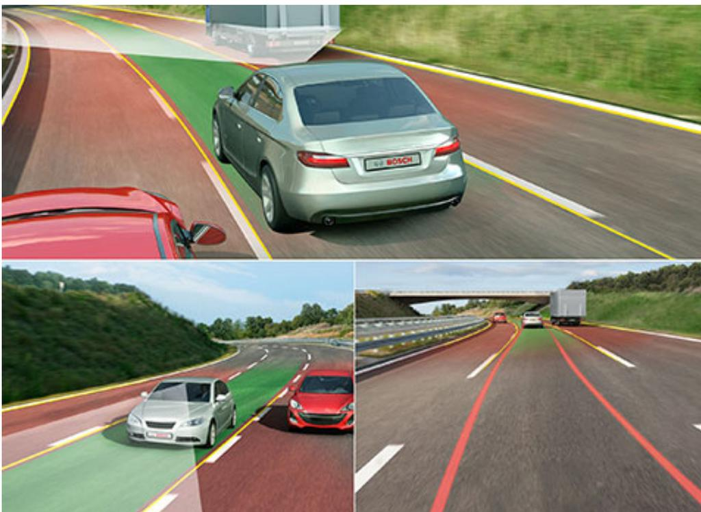
Spurhalteassistenten nutzen eine kleine hinter der Windschutzscheibe montierte Videokamera, um die Fahrbahnmarkierungen vor dem Fahrzeug zu detektieren und diese mit der Position des Fahrzeugs in der Spur zu vergleichen: das System wertet Kontrastunterschiede zwischen Straßenbelag und Begrenzungslinien aus. Erkennt das System, dass ein definierter Mindestabstand zur Fahrbahnbegrenzung unterschritten wird, wird es aktiv.
