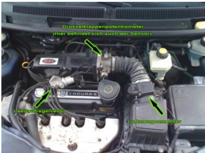
Drosselklappensensoren sind an der Drosselklappenachse befestigt. Ihre Aufgabe besteht darin, den Öffnungswinkel der Drosselklappe zu erfassen und diese Information in Form eines elektrischen Signals an das Motorsteuergerät weiter zu geben. Anhand dieses Wertes errechnet die Motorelektronik die Kraftstoffmenge, die eingespritzt wird. Diese ist abhängig von weiteren Faktoren, wie der Motortemperatur, dem Luftdruck und der Drehzahl.
