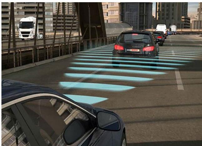
Das Fahren bei dichtem Straßenverkehr und das Halten des richtigen Sicherheitsabstands zum vorausfahrenden Fahrzeug erfordert hohe Konzentration und ist auf Dauer anstrengend. Die Abstandsregelung ist ein Fahrerassistenzsystem, das den Autofahrer aktiv unterstützt, einen definierten Abstand zum vorausfahrenden Fahrzeug einzuhalten. Das System, oftmals auch als Adaptive Cruise Control (ACC) bezeichnet, basiert auf dem Tempomaten, der eine festgelegte Fahrgeschwindigkeit automatisch hält.
