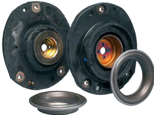
überwiegend McPherson-Federbeine zum Einsatz. Dabei handelt es sich um eine besondere Form der Radaufhängung für die Vorderachse. Um diese an der Karosserie abzustützen, werden Federbeinlager eingesetzt, die ein Kugellager beinhalten. Dieses ist sowohl in der Lage hohe Kräfte aufzunehmen, als auch leichtgängige Drehbewegungen des Federbeins zuzulassen.
