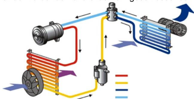
System, den sogenannten „Kältemittelkreislauf“.
