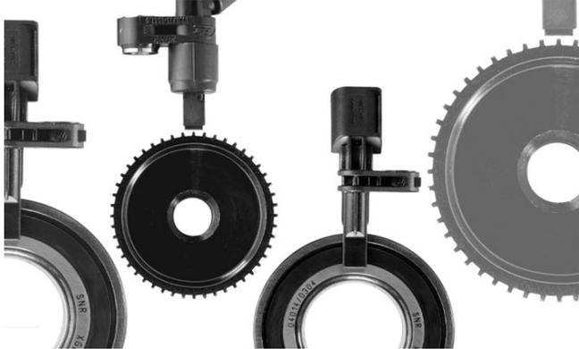
(ASR) erweitert. Durch die Erweiterung ist es notwendig, Sensorsysteme zu verwenden, die ein verwertbares Signal bei sehr geringen Geschwindigkeiten, quasi bis zum Stillstand abgeben. Hier kommen aktive Sensoren zum Einsatz. Diese arbeiten nach dem Magnetoresistiv-Prinzip: Sie werden mit Spannung versorgt und greifen ihr Signal von einem sogenannten „Encoder-Rad“ – einem magnetischen Impulsgeber – ab.
