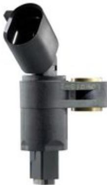
Die Aufgabe der Raddrehzahlsensoren, auch Radsensoren genannt, besteht darin, die Drehzahl der Räder zu erfassen und diese Information in Form eines Signals an das Steuergerät des ABS oder ESP® zu senden. Neuere Sensoren erfassen zusätzlich die Drehrichtung der Räder.
