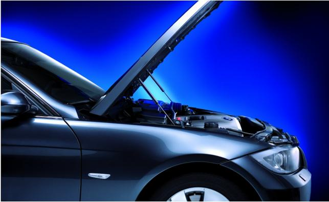
Schließen der Kofferraum-, beziehungsweise Heckklappe sowie der Motorhaube. Zur Bedienung der Heckklappe und Motorhaube mit Gasfederunterstützung genügt eine Hand. Beim Öffnen der Klappe wird diese von der Gasdruckfeder sicher und zuverlässig in der Endposition gehalten. Beim Schließen dämpft die Feder die Bewegung sanft ab und die Klappe fällt leise ins Schloss.
