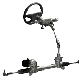
Elektrisches Servo-Lenksystem ©ZF Aftermarket
