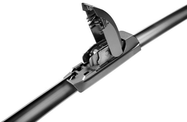
diesen wird die Verteilung der Auflagekraft auf den Wischgummi nicht mehr von den Krallen der Wischblattbügel übernommen. Diese Aufgabe übernehmen hier zwei speziell auf die Scheibe abgestimmte, vorgebogene Federschienen. Diese bewirken einen noch gleichmäßigeren Anpressdruck der Wischlippe auf die Scheibe. Das mindert den
