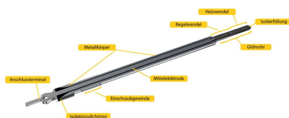
Querschnitt Metallstabglühkerzen
