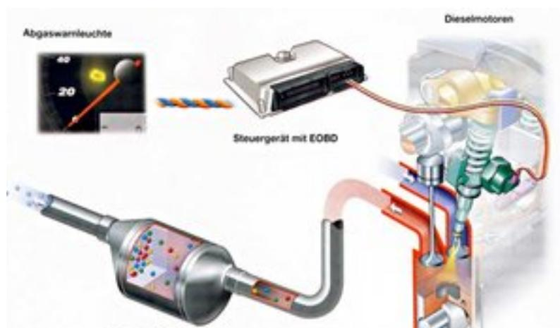
EOBD Austausch-Katalysatoren für Euro 3- und Euro 4- Fahrzeuge mit einer europäischen On-Board-Diagnose (EOBD) werden als EOBD-fähige Katalysatoren bezeichnet. Vor allem neuere Fahrzeugmodelle verfügen über eine EOBD. Auch die neuen Generationen von Diesel-Fahrzeugen sind in der Regel mit der EOBD-Funktion ausgestattet. Die EOBD hat die Aufgabe, während der Fahrt alle
