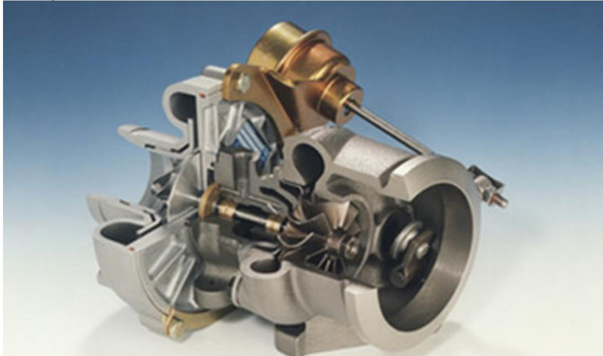
sind durch eine gemeinsame Welle mechanisch fest miteinander verbunden. Die Turbine wird von den Abgasen des Motors angetrieben und liefert die Antriebsenergie für den Verdichter. Bei Turboladern werden in
