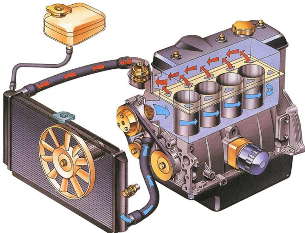
zu Schäden an der Wasserpumpe kommen. Durch regelmäßiges Überprüfen des gesamten Heiz- und Kühlsystems im Rahmen der Wartungsintervalle können relevante Beschädigungen, Undichtheiten sowie übermäßiger Verschleiß rechtzeitig festgestellt und beseitigt werden.
