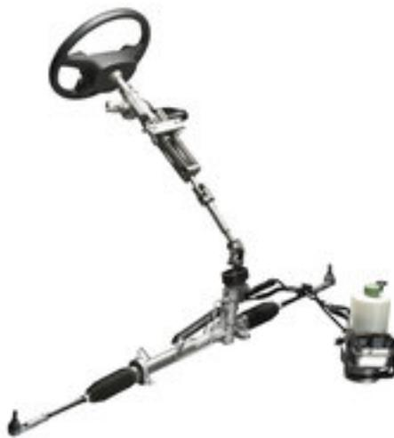
Bei einem elektrohydraulischen Servo-Lenksystem, auch Electrically Powered Hydraulic Steering (EPHS) genannt, wird die riemenangetriebene Lenkhelferpumpe durch eine elektrische Hydraulikpumpe ersetzt- dem sogenannten Motor-Pumpen-Aggregat (MPA).
