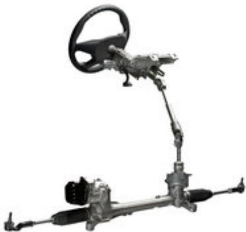
Elektrisch unterstützte Lenksysteme, auch Electrically Powered Steering (EPS) genannt, verzichten vollständig auf Hydraulikflüssigkeit. Bei diesen Systemen wird die Lenkbewegung durch einen Elektromotor unterstützt.
