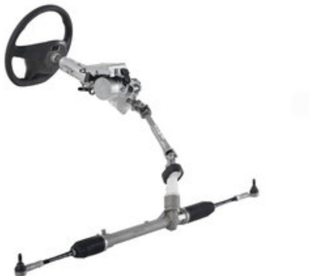
Bei der elektrischen Servolenkung mit Lenksäulen'antrieb (Column Drive EPS) handelt es sich um eine Variante, bei der das zusätzliche Lenkmoment über ein Schneckenradgetriebe an der Lenksäule auf die Lenkwelle übertragen wird. Dieses System kommt in kleineren Fahrzeugen mit wenig Platz im Motorraum zur Anwendung.
