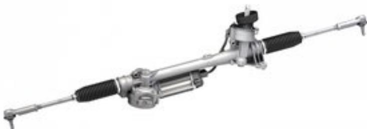
Fahrzeuges. Dank intelligenten [Assistenzsystemen](#) ist es möglich, sowohl das Handling als auch die Fahrdynamik optimal aufeinander abzustimmen. Um den Kraftaufwand beim Lenken möglichst gering zu halten, kommen in modernen Fahrzeugen sogenannte Servolenkungen zum Einsatz. Dabei wird zwischen einer elektrischen und hydraulischen Servolenkung unterschieden.
