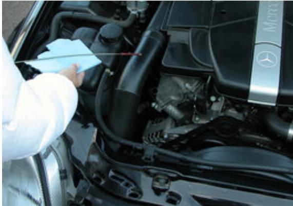
werden. Werden die Wechselintervalle nicht eingehalten, besteht die Gefahr, dass mechanische Bauteile des Motors schneller verschleifen. Die Folge können teure Reparaturen oder Motorschäden sein.
